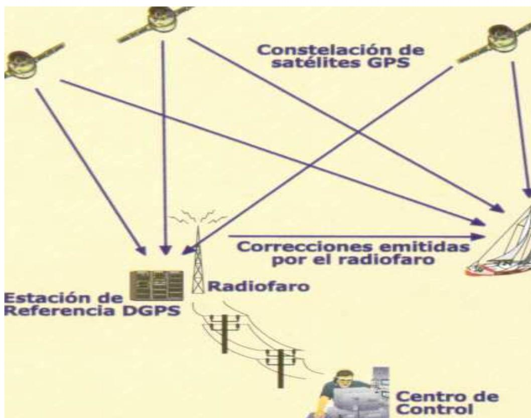
Esquema de funcionamiento de DGPS
